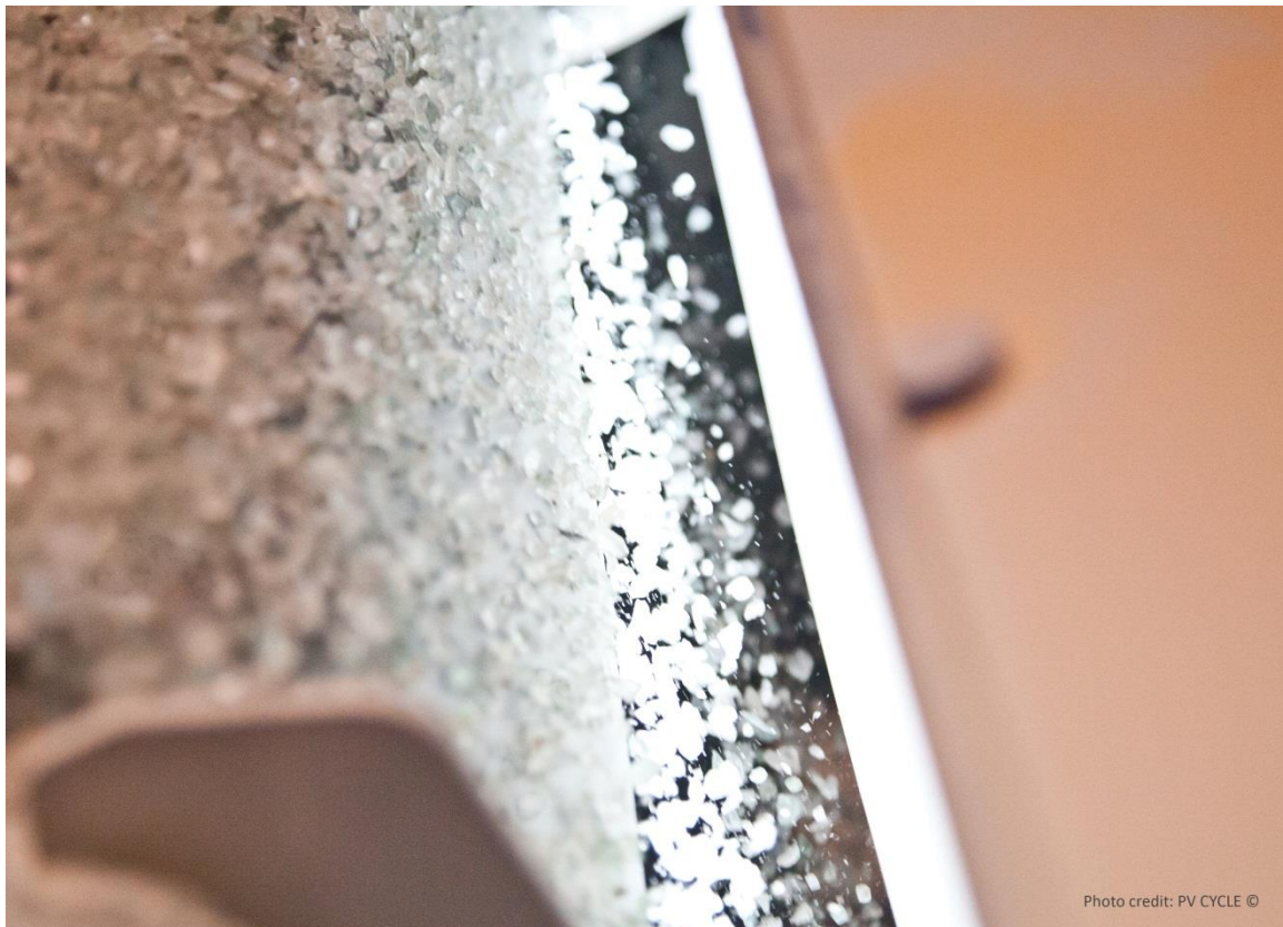
Figura 5 - I granuli vetrosi sono l'80% del materiale riciclato da un modulo [PV CYCLE].
