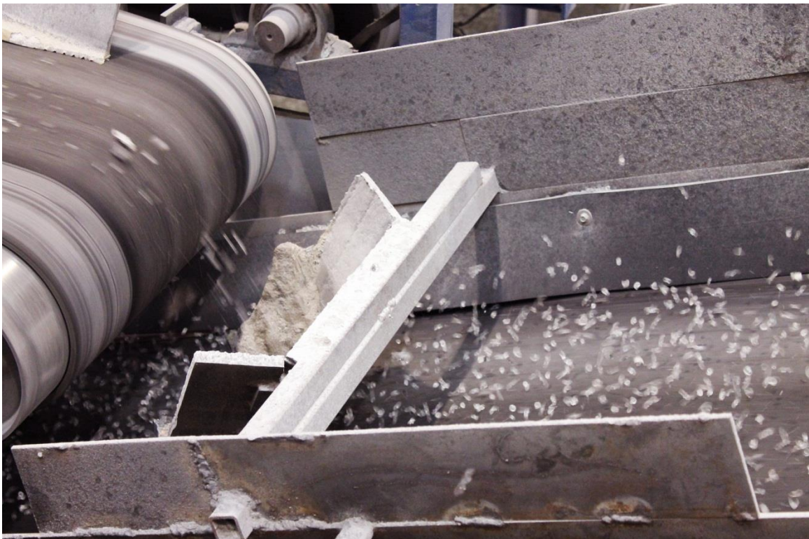
Figura 6 - Processo di frantumazione e di separazione dei materiali [Fonte: PV CYCLE].
