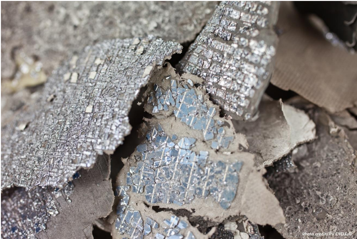
Figura 7 - Celle fotovoltaiche in Silicio distrutte con frantumatrici industriali [PV CYCLE].
